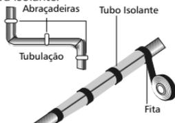
2. Fixe a parte excedente do cabo elétrico na tubulação ou na unidade externa.
