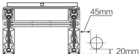
3.3 Faça, na parede, um furo de  $\varnothing 70\text{mm}$ , com uma pequena inclinação voltada para baixo e para o exterior, de 5 a 10mm.
