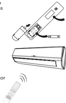
Procedimento para alteração da escala de temperatura entre °C e °F:
