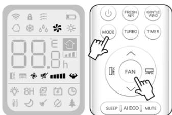
Para ajustar a velocidade de ar pressione o botão (FAN), e selecione conforme a sequência:
