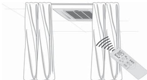
Se o receptor de sinal infravermelho na unidade interna for exposto diretamente aos raios solares, esta poderá não funcionar adequadamente. Bloqueie a incidência dos raios solares até eliminar a exposição.
