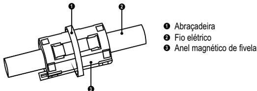
O anel magnético de fivela deve ser adicionado ao cabo de comunicação da linha de energia da unidade externa e interna. O anel magnético de fivela adicionado deve ser fixado na saída do cabo de comunicação da linha de energia próximo ao lado da unidade externa; a etapa de operação detalhada para a fivela magnética é a seguinte:
