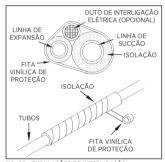
FIG. 83 - TUBULAÇÕES DE INTERLIGAÇÃO
