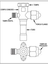
FIG. 71 - VÁLVULA DE SERVIÇO DAS LINHAS DE SUCÇÃO E EXPANSÃO
