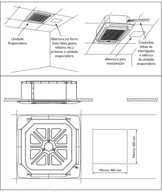
FIG. 24 - ABERTURA PARA MANUTENÇÃO
