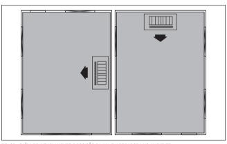
FIG. 35 - SAÍDA DE INSUFLAMENTO E POSIÇÃO DA UN. EVAPORADORA NO AMBIENTE
