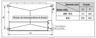
FIG. 56 - POSIÇÃO E DIMENSÕES DOS SUPORTES PARA FIXAÇÃO DA UNIDADE
