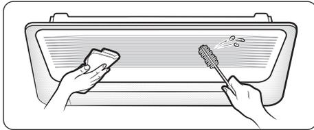
Limpe a superfície da unidade interna com um pano úmido.
