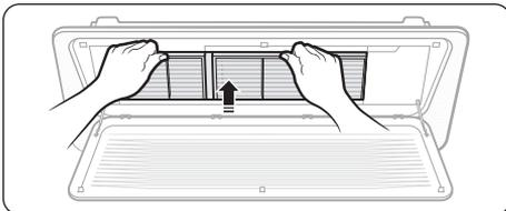
Para montar o filtro de ar, proceda na ordem inversa do processo de desmontagem.
