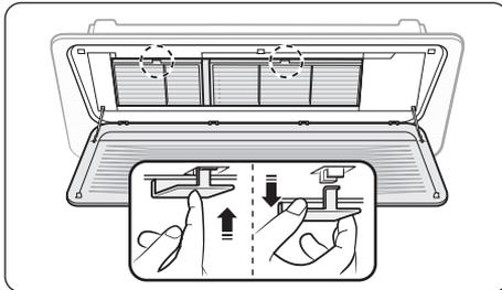
Pressione os sinais PUSH (▽) no filtro de ar. Segure as abas do filtro de ar e remova-o da unidade interna com as mãos.
