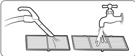
Limpe o filtro de ar com um aspirador ou escova macia. Se o pó for muito espesso, enxágue com água corrente e seque em uma área ventilada.
