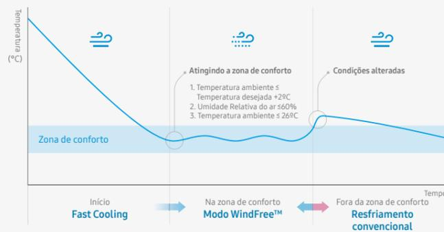
Temperatura e umidade são fatores chave que afetam o conforto dos ocupantes. Normalmente as pessoas se sentem bem com temperatura entre 23 e 26°C e com umidade próxima de 60%. A tecnologia WindFree™ Samsung conta com sensores de umidade, para que a operação esteja sempre no modo mais adequado.
