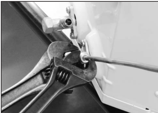
FIG. 35 - FIXAÇÃO DA PORCA
