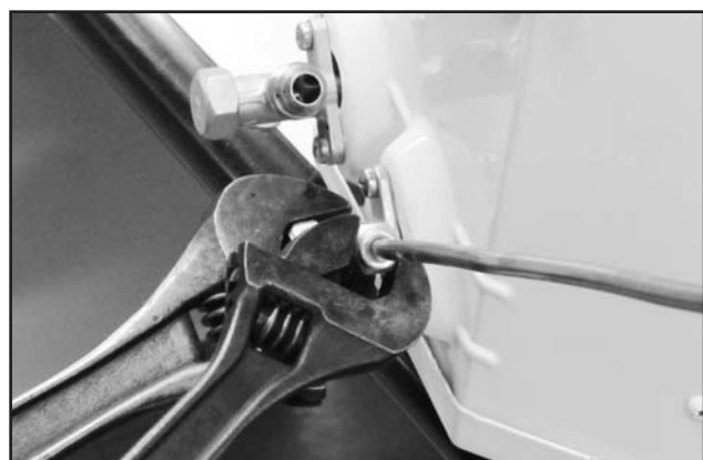
FIG. 31 - FIXAÇÃO DA PORCA
